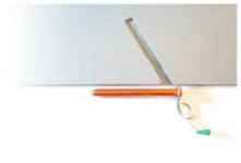
... die Schraube wieder 60° ansetzen und zweites Loch bohren...
